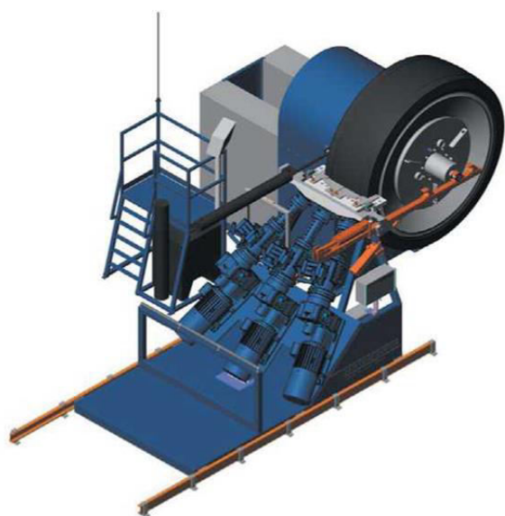
Рис. 4. Опытный образец сборочного станка «Base Constructor для обрезаживания каркасов КГШ и СКГШ» фирмы VMI Group (Голландия).
