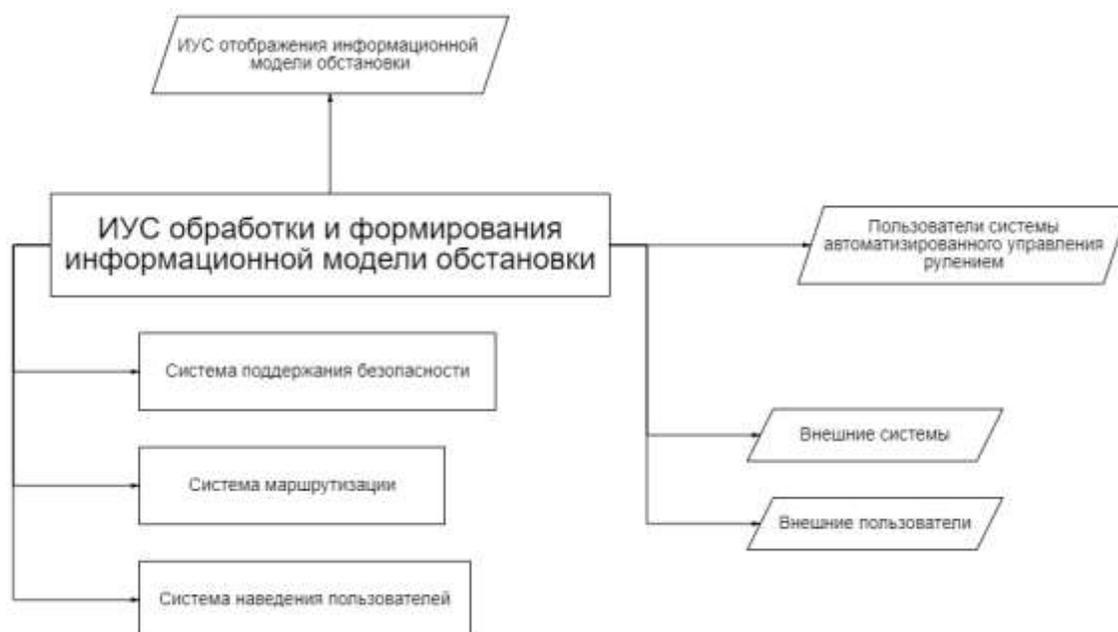
Рисунок 1 – Порядок взаимодействия подсистем автоматизированной системы управления рулением
