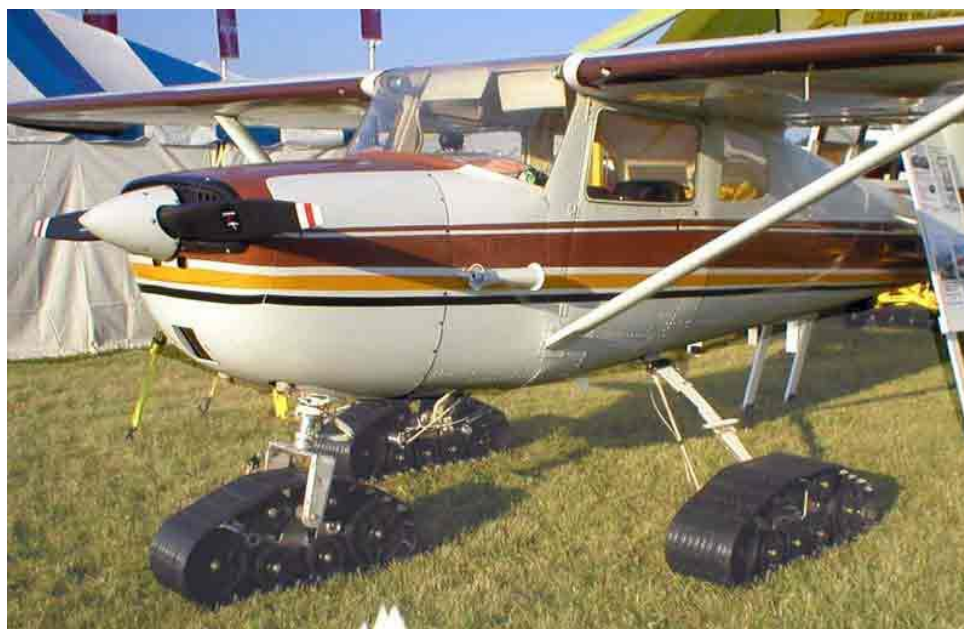
Рисунок 8 – Пример гусеничного шасси
