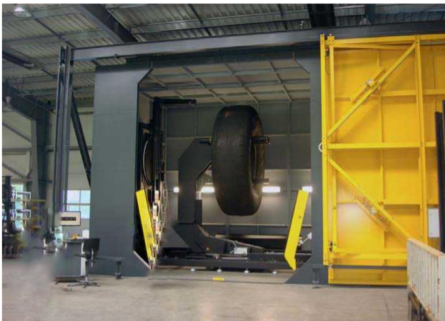
Рис. 5. Установка для вакуумной ширографии КГШ и СКГШ в Поволжской шинной компании.
