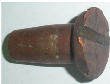
Рис. 10. Износ электрода контактной сварки
