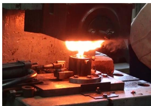
Рис. 4. Штамповка охлаждающего канала
